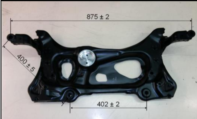
G2-1) Subframe dismounted
